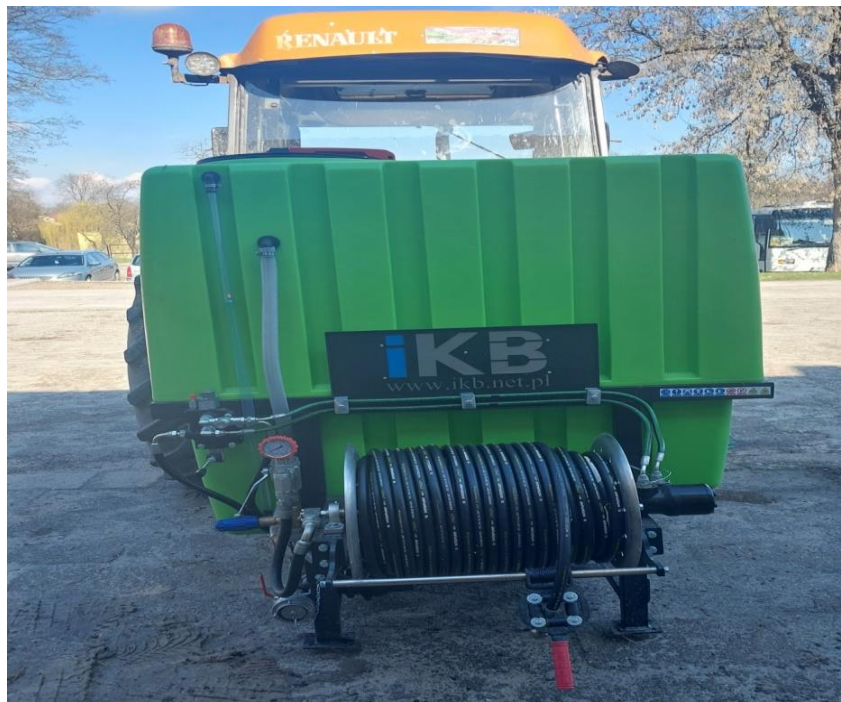
Rys. 1. Urządzenie do ciśnieniowego udrażniania sieci kanalizacyjnej.
